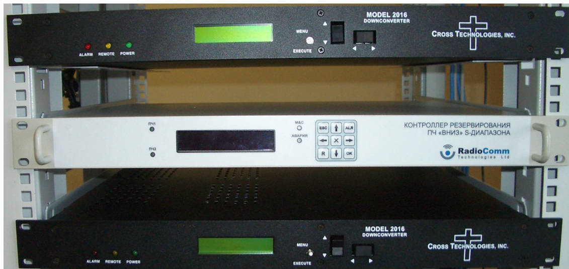
Рисунок 1.4 – Внешний вид оборудования системы резервирования Состав системы резервирования 1:1.
